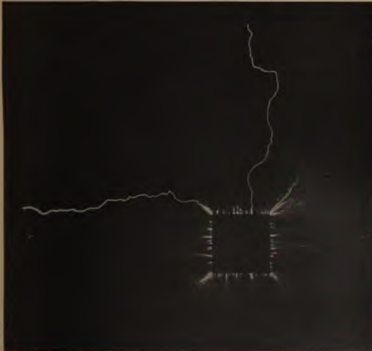
Abb. 362. Gleitfunken auf einer Hartgummiplatte und Randentladungen (Büschellicht) an der Elektrode.
